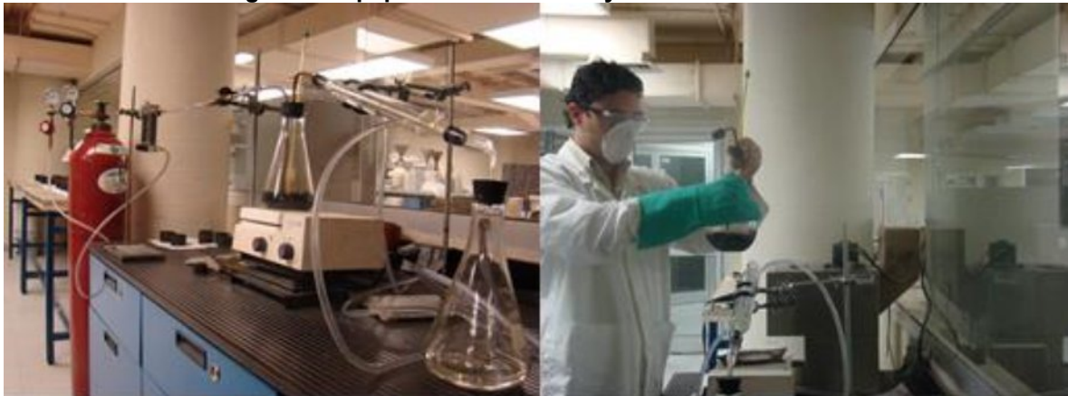
Figura 1: Equipo método de ensayo Abson modificado
